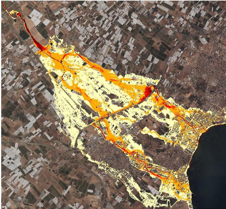
Figura 37. Caudal específico obtenido en el cálculo hidráulico del modelo de la rambla de Cobatillas.
